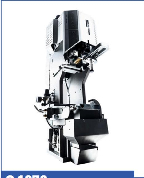
Queste nuove presse sono adatte alla serie di macchine Komax Alpha 530-550 di ultima generazione, e permettono di ridurre i tempi di conversione tra un cavo e l'altro grazie alla nuova tastiera installata sulla pressa che permette di regolare e centrare il cavo sotto il miniapplicatore.
